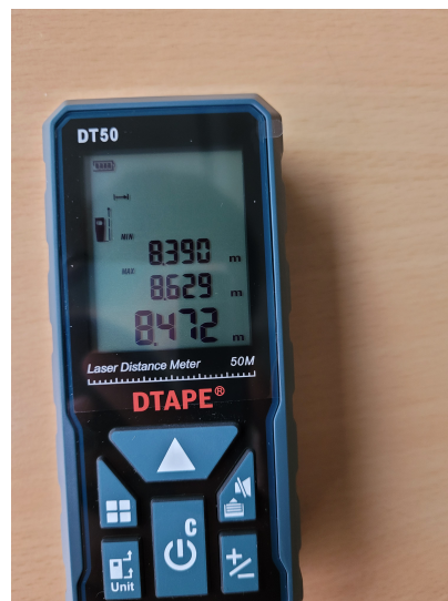
Abbildung 7: Messung der Fallstrecke mit einem Laser-Entfernungsmesser, die minimale Entfernung von 8,390 m wurde genommen (eigene Darstellung)
